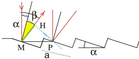
On considère un réseau plan ayant le profil en dents de scie ci-contre et fonctionnant en réflexion. Un tel réseau est dit «réseau échelette». Il comporte N traits.
